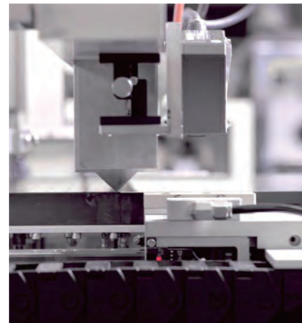
▲Manz黃光Track Line解決方案中的關鍵製程設備—狹縫式塗佈，光阻膜厚均一性≤2.5%。
