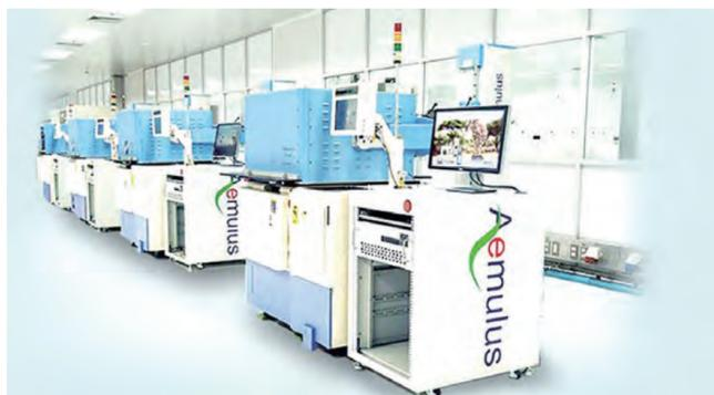
▲ Amoeba AMB 4600 是世界上第一個具有高度可重組性質的自動化測試設備的測試平台。該測試系統可在數字、模擬、或射頻/混合訊號互換的特性。
