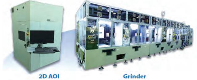
▲均豪精密之晶圓瑕疵檢查機(2D AOI)與平面研磨設備(Grinding)。
