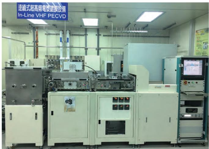
▲ 圖為財團法人金屬工業研究發展中心自主開發之「連續式超高頻電漿鍍膜設備In-Line VHF PECVD for HIT Solar Cell」。
