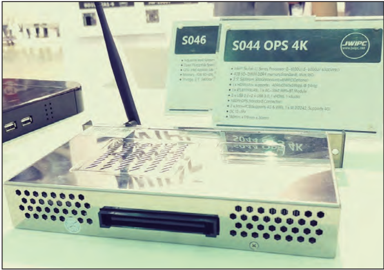
▲ JWIPC數位電子看板主機，使用標準尺寸機身和標準連結介面，不同品牌型號的螢幕和主機可以隨意變換搭配。 毛履兆攝
