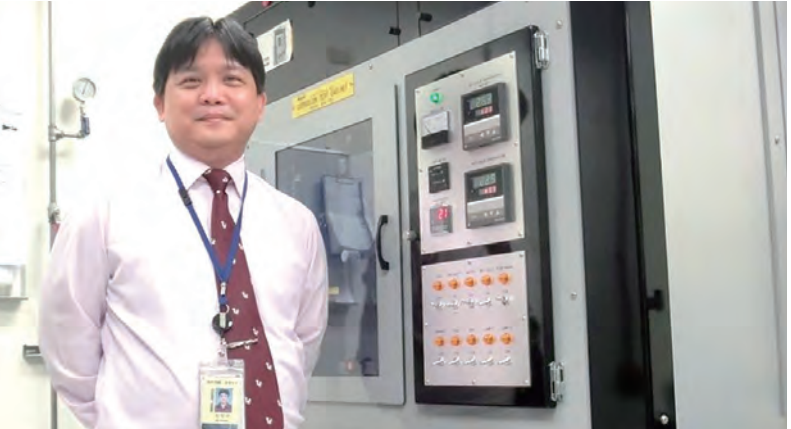
▲ 閎康科技可靠度工程事業群處長謝翰坤表示，閎康科技可靠度實驗室針對各種應力設備積極布局，如斥資引進高階氣體腐蝕試驗設備(如圖)，可對PCB等元件進行腐蝕性測試。
