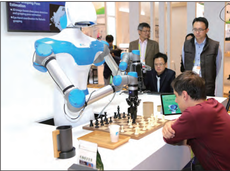
▲ 工研院智慧視覺系統機器人採用雙鏡頭與紅外線發射器組成，機械手臂可快速辨識西洋棋棋子與空間位置。 劉尚昀攝
