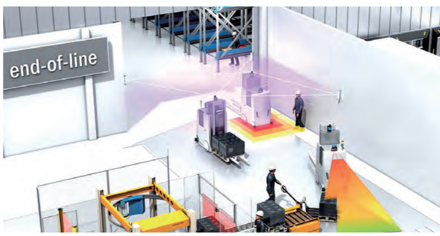
▲自動導航無人搬運車透過SICK的產品NAV導航移動同時兼顧防止人員碰撞意外。
